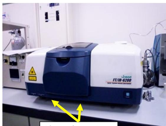
元に戻すときは、前面パネルの高さを合わせてはめ込み、少し押付け気味にしてねじをとめる。試料室のふたは勢いよく閉めず、取手をもってそっと閉じること。
