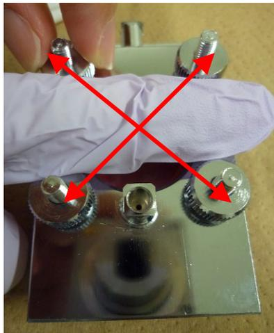
このとき、ネジが落ちて窓板を傷つけるのを防ぐため、ネジを取り付けるときは穴を指などでふさぎながらネジを締める。
