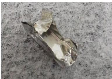
2. 長い一辺を内側に折りたたみ、L字型にする (T字型でもよい)。上端の出口をピンセットなどでふさいだ状態で、軽くスパチュラでつぶして、中の空気を抜くようにする。ここでは、試料がこぼれやすいので、むや
