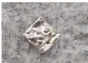
6. 2~3 cm 位の高さから何回か落とし、粉末が漏れないか確認する。
