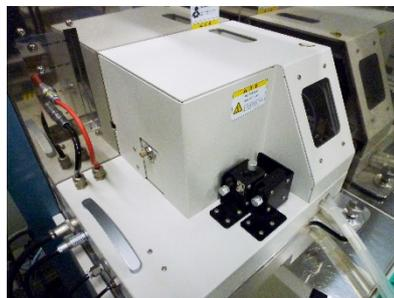
モードを切り替えるときは、コネクタを入れ替える。カバーはネジ回しになっているので、まずカバーを外してからゆっくりコードを引き抜く。取り付けるときは、コネクタを差し込んだ後、カバーを閉める。
