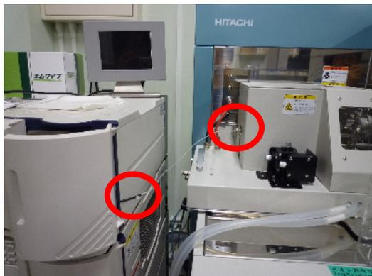
※ LC 出口チューブをイオン源に接続、またはイオン源から取りはずすときは、必ず **Instrument On** にしてから行うこと!
