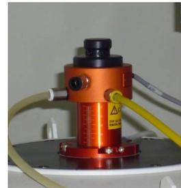
C-5 [Magnet] 試料管ゲージを外し、ローターを装填口に乗せる。
